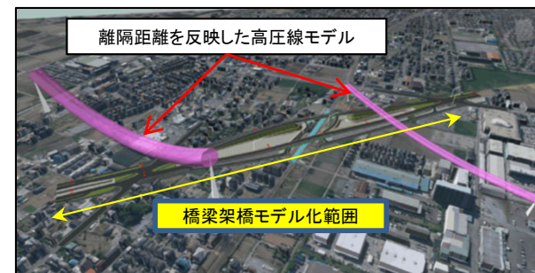
橋梁と架空線の離隔確認
